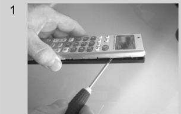
Bitte entfernen Sie die Abdeckung indem Sie einen Schraubenzieher nutzen.
